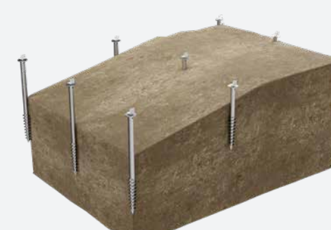
Etape 1 Installation des vis de fondation
